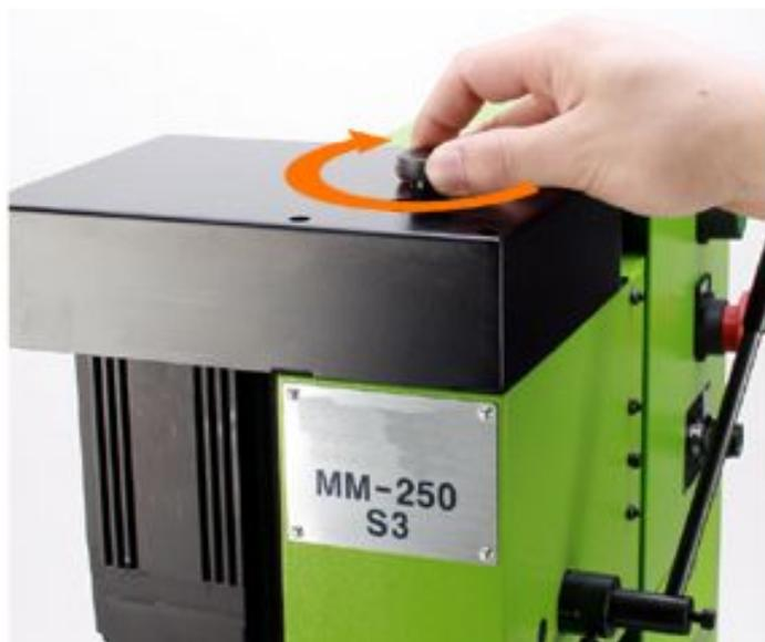
主軸のテーパ部にコレットホルダーのテーパ部をセットし、主軸上部にある、ツマミを回しホルダーを固定します。
